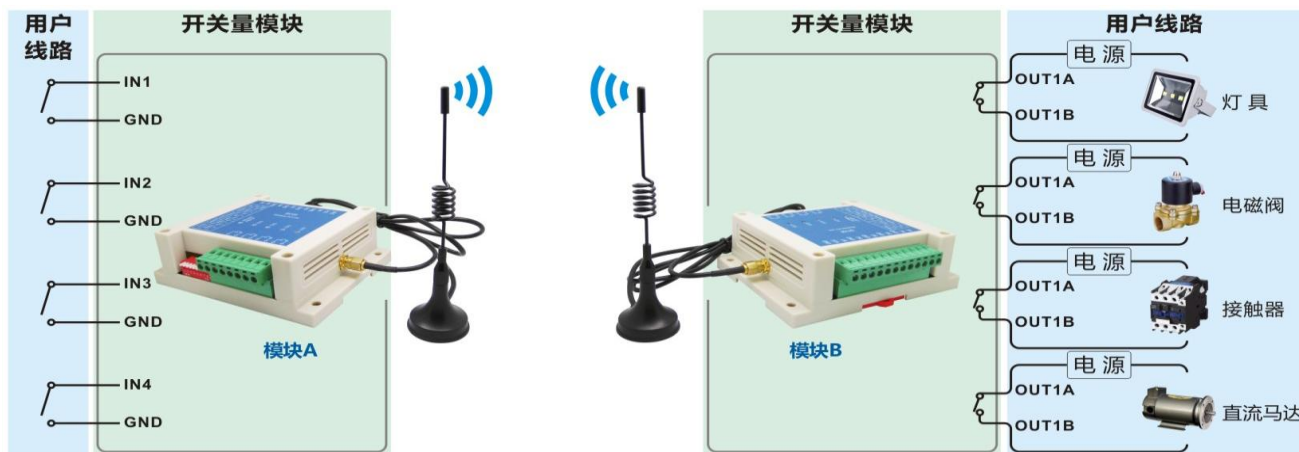
模块A的输入INx与GND短接，模块B的OUTx继电器便吸合；模块A的输入INx与GND断开（或悬空），模块B的OUTx继电器便断开。
